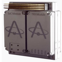
그림 5 ETRISat 위성체와 SDR 페이로드
